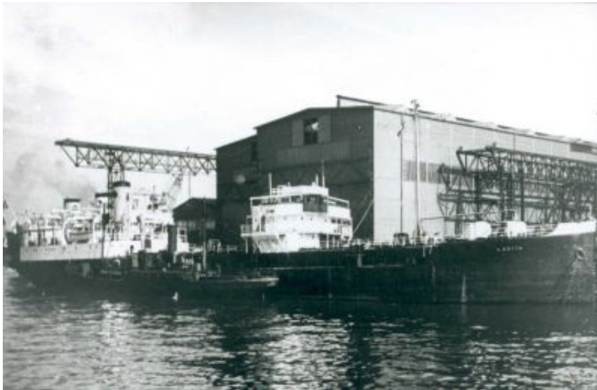
17) Lucita 1926 (roepnaam PJAK) Diensttijd 1926-1954 Bouwer : Cantieri Navale Triestino Monfalcone, Itale (bouwnummer 305). Tonnage : 2.604 brt., 1.136 nto. en 3.268 dwt. L X B X D X H : 92,96 X 15,34 X 4,60 X 6,09 mt. Machines : 2 R.D.M. triple-machines 1.500 pk, snelheid 9,5 knopen. In november 1926 in dienst gesteld. 1926-1954 Lucita C.S.M. Op 15-09-'54 aanvang sloop in Nederland
